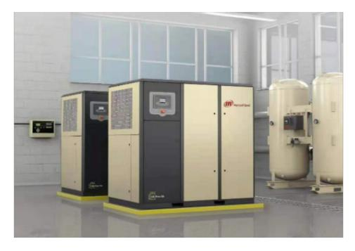
更换部件尽量采用原装公司部件,否则出现匹配问题,供应商不会负责[4]。清洁散热空压机每运行2000h 左右,为散热表面灰尘,需将风扇支架上的冷却器吹扫孔盖打开,用吹尘对冷却器进行吹扫,直至散热表面灰 尘吹扫干净。尚若散热表面污垢严重,难以吹扫干净,可将冷却器卸下,倒出冷却器内的油并将四个进出口封 闭以防止污物进入,然后用压缩空气吹除两面的灰尘或用水冲洗,吹干表面的水渍。装回原位[4]。切记!勿用 铁刷等硬物刮除污物,以免损坏散热器表面。
