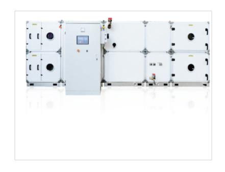
新风机组是提供新鲜空气的一种空气调节设备,随着人们对生活环境要求的提高,市民和客户对新风机组的应用也越发关注。那么您知道如何保养新风机组吗? 1、风口及过滤网洗濯: 用户内需每隔6个月请正儿八经人手用的清洁药剂清洗出风口以及过滤网。2、检查新风机组风速及主机接线: 100\*\*建议用户定期请人反省系统并调剂风量,消弭隐患,作保新风体系力所能及有惊无险正常干活。3、注意日常新风机组的工作电流,经常检查电气线路和电气设备,保证各电气部件性能安全、可靠、稳定、接线牢固。4、新风机组设备长期停止运行时应关闭新风阀门,放掉换热器内存水,放松风机皮带,润滑部分加注润滑油。同时,要注意皮带磨损情况,如果皮带磨损严重及时更换。
