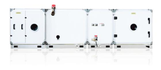
在一次回风空调机组中,如果冬季室外空气焓值低于一定值时,就需要对新风进行预热,否则混合后的空气无法处理到送风状态点。而在洁净厂房的空气处理中常用到新风机组=系统。舒适空调系统的新风机组用于处理满足空调房间的人员的新风需求的新风量,风量相对较小,而对于洁净厂房的空调系统,一方面由于洁净厂房的换气次数比较大,千级洁净室为50~60次/h□万级洁净室为15~25次/h□十万级洁净室为10~15次/h□新风机组处理的风量比较大;另一方面考虑洁净度的要求,洁净室风口末端安装有高效过滤器,而高效过滤器的容尘能力有限,因此需要在新风机组中安装初、中效过滤器。当遇上冰雨天气(冰雨天气是由于冷暖空气对流,大气上层气温在冰点以上,而地面温度在冰点以下,使得雨水在下降过程中结成冰粒而形成的特殊降水方式),过滤器视空气中冰晶为颗粒物而阻拦,水滴在零度以下的滤材上结冰,并迅速地将过滤器封堵,导致新风机组严重出力不足,进而影响整个洁净厂房的洁净度及空气品质。组合式新风机组适用于很多场所,基本好多地方都可以看见它的身影,可以说是与我们的生活息息相关。河南横流新风机组供应
