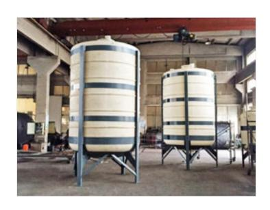
塑料储罐的特点:由于线性低密度聚乙烯 LLDPE 优异的性能和滚塑储罐特殊的结构,使用寿命长达15年以上。耐化学性能非常优异,除少数溶液可以溶胀它外,几乎可以耐大部分物质溶液。塑料储罐(贮罐)具有内外防腐的特点,可放置在高腐蚀环境下。滚塑防腐储罐在大规格大容量大体积的产品上有非常大的优势,尽管体积大,但光然保持一次成型整体性的特点,这是其它储罐工艺所达不到之处。与传统防腐储罐相比,价格低廉,性能价格比高。塑料储罐(贮罐)一次成型整体性好,无焊缝,\*\*渗漏,抗冲击性能强,拉伸强度高,抗氧化、抗老化性能好,符合卫生食品标准。杭州卧式塑料储罐厂家塑料储罐使用注意事项:需搬运产品时,须放干水塔体内的所有液体,产品处于空置的情况下方可搬运。
