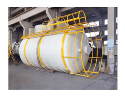
塑料储罐的基本使用和维护:塑料储罐软化出现变形塑料储罐所使用塑料的很小软化点为108℃,较大 断 裂点为-70℃。塑料储罐所以,一般来说可用以-40℃——60℃温度的液态。如液态比例较重或温度超过60℃时,应选择钢制里衬塑料防腐罐,避免 PE塑料罐软化出现变形。假如使用塑料储罐开展化学反应或稀释,应提早开展相应的试验,确定反应或稀释的比较高温度。塑料储罐的软化出现变形也与罐体的壁厚和塬材料相关。塑料储罐为了更好地控制成本,降低罐体的壁厚或在高温或太阳光照射下混合收购材料,很有必要使罐体充斥着液态并出现变形。
