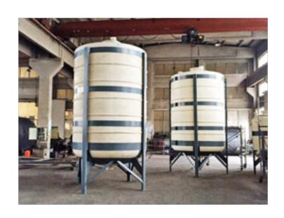
塑料储罐有哪些特征: 1、塑料储罐的抗腐蚀能力强: 对大气、浓度较高的酸、碱、盐以及多种油类和溶剂都有较好的抵抗能力。已应用到化工防腐的各个方面,正在取代碳钢、不锈钢、木材、有色金属等。 2、塑料储罐的质量轻,强度大: 相对密度在1.5-2.0之间,只有碳钢的1/4-1/5,可是拉伸强度却接近,甚至超过碳素钢,而比强度可以与高级合金钢相比。因此,在航空、火箭、宇宙飞行器、高压容器以及在其他需要减轻自重的制品应用中,都具有很好成效。某些环氧FRP的拉伸、弯曲和压缩强度均能达到400Mpa以上。在安装塑料储罐时要注意的事项: 大规格储罐在安装时要注意安全,尽量用吊机。杭州卧式塑料储罐厂家
